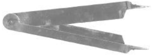
Fig. 37: Frühform eines Proportionalzirkels mit Spitzen; 17. Jahrhundert
