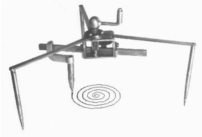
Fig. 63: Spiralzirkel mit „vollständiger“ Spirale
